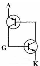
6. (3) 機器腳踏車電路圖中，下圖所示的電路為①運算放大器②矽控整流器③達靈頓放大電路④發電機整流電路。
