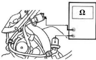
58. (2) 如下圖所示，當線圈系統作用正常時，下列敘述何者正確？①若量出的  $\Omega$  值為  $\infty$  時，表示搭鐵②若量出的  $\Omega$  值為  $\infty$  時，表示斷路③若量出的  $\Omega$  值為  $\infty$  時，表示正常④若量出的  $\Omega$  值為  $\infty$  時，表示短路。
