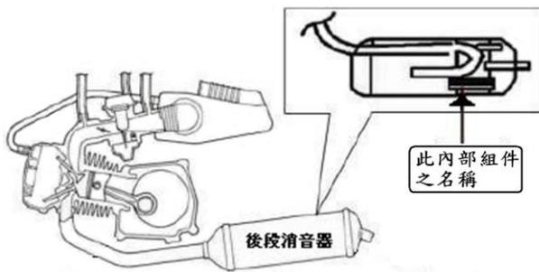
11. (1) 關於下圖元件之量測，下列敘述何者正確？①三用電錶需選擇在歐姆錶檔位②三用電錶需選擇在電壓錶檔位③三用電錶需選擇在電流錶檔位④三用電錶需選擇在轉速錶檔位。
