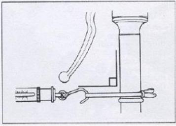
5. (4) 關於大型重型機車下圖所示之作業，下列敘述何者正確？①油門接合間隙檢查②油門轉動部份施以機油潤滑
