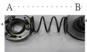
7. (1) 關於 CVT 變速機構，若驅動盤與傳動盤的傳動有效半徑分別為 3 cm 與 5 cm，傳動效率為 90%，當驅動盤的轉速為 2000rpm，試問傳動盤的轉速為多少？①18②20③22④24 轉/秒。
