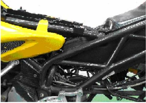
9. (1) 如下圖所示，機器腳踏車主配線上的束帶，必須確實固定於車架上，且須使線束接觸束帶絕緣面，其 A 技師與 B 技師之固定方式何者正確？①A 對 B 錯②A 錯 B 對③A 與 B 都錯④A 與 B 都對。
