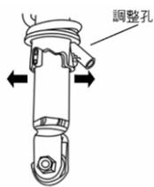
7. (3) 機器腳踏車後雙避震器系統之後輪偏擺故障，下列何者非可能之故障原因？①輪圈變形②輪胎偏磨耗③轉向軸軸承間隙過小④左右後避震器彈簧疲乏。
