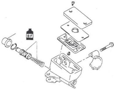
9. (2) 機器腳踏車煞車拉柄施加 10kg 作用力於液壓煞車系統中，為提高車輪制動力，下列敘述何者正確？①使總泵活塞面積大於分泵活塞面積②使總泵活塞面積小於分泵活塞面積③使總泵活塞面積等於分泵活塞面積④活塞面積不會影響系統油壓。
