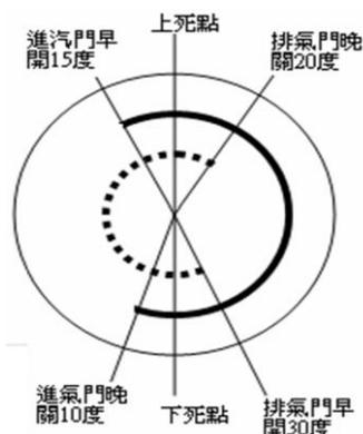
107. (4) 某四行程汽油引擎如下圖，其汽門重疊開啟度數為？① $15^\circ$  ② $20^\circ$  ③ $30^\circ$  ④ $35^\circ$ 。
